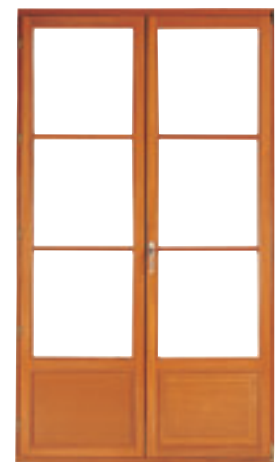
Primabelle porte-fenêtre Bois exotique rouge (avec option Oscillo-Battant) Pièce d'appui bois avec protection aluminium ou seuil aluminium 20 mm Soubassement constitué d'un panneau plate bande aux 2 faces avec âme en mousse
